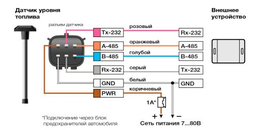
**Внимание:** настройка ДУТ ONE.MAX возможна только по интерфейсу RS-232. Выдача данных как по интерфейсу RS-232, так и по интерфейсу RS-485.
